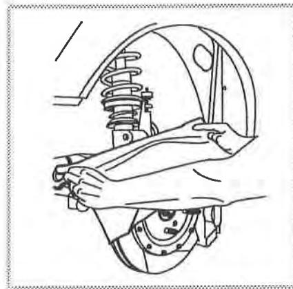
① soit protéger lors de chaque intervention (à l'assistance ou après rallye lors du nettoyage) le disque de frein par un chiffon pour éviter que des corps étrangers (gravillons etc ...) ne tombent dans les aubes du disque et viennent par la suite lors du remontage de la roue s'intercaler entre le bol du disque et le moyeu de roue et entraînent ainsi un mauvais serrage de la roue.
