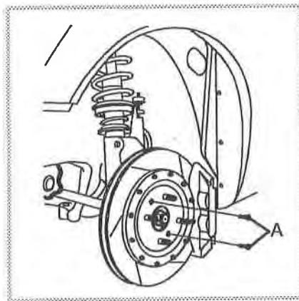
2 soit fixer les bols de disques de freins avant sur les moyeux en A par des vis à tête hexagonale diam: 6 mm. Dans ce cas il est impératif de vérifier régulièrement le serrage de ces vis.
