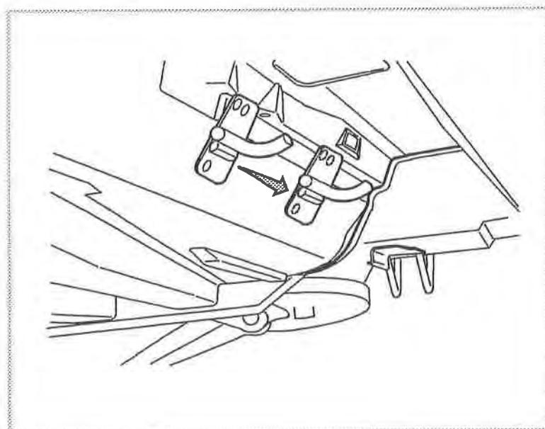
N.B. Pour les véhicules antérieurs à 1999, il est impératif pour la pose du silencieux avec pot cata intégré de dessouder et déplacer vers l'avant la patte de fixation sur caisse du silencieux.
