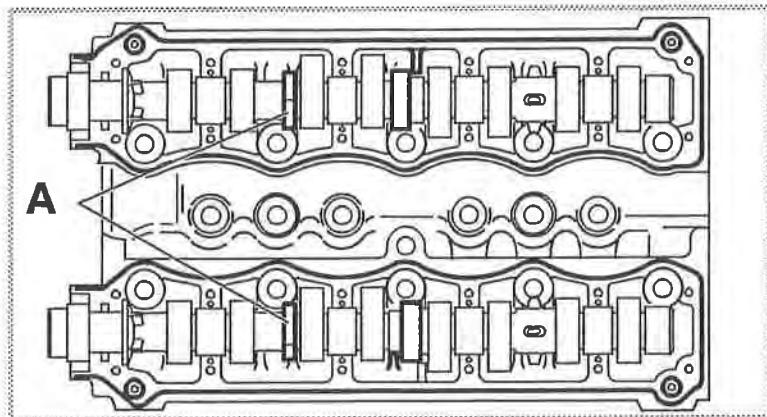
N.B. il est recommandé de meuler légèrement les carrés de maintien des arbres à cames repérés ci-dessus en A afin d'éviter toute proximité avec les poussoirs.
