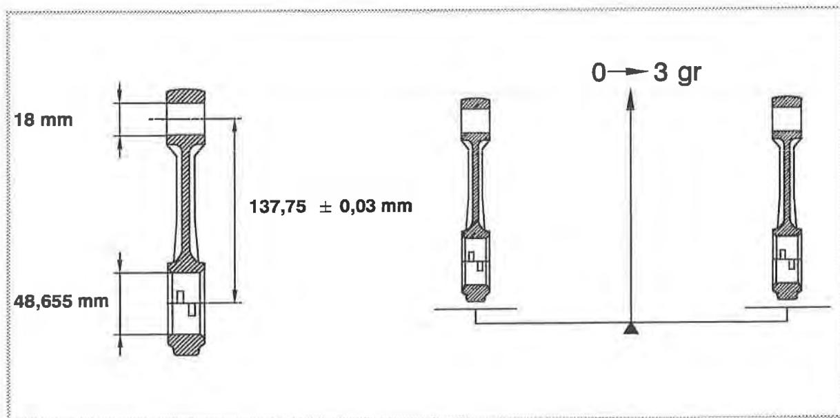
poids mini unitaire (avec coussinets, vis et écrous): 527 g.
