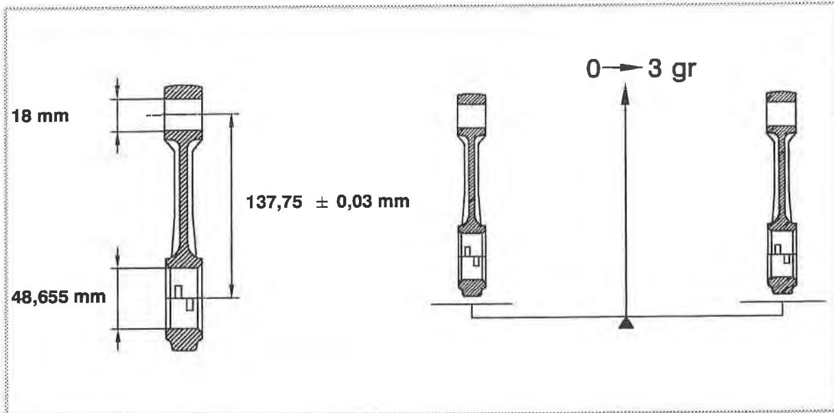
② poids mini unitaire (avec coussinets, vis et écrous): 527 g.
