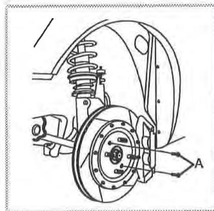
② soit fixer les bols de disques de freins avant sur les moyeux en A par des vis à tête hexagonale diam: 6 mm. Dans ce cas il est impératif de vérifier régulièrement le serrage de ces vis.
