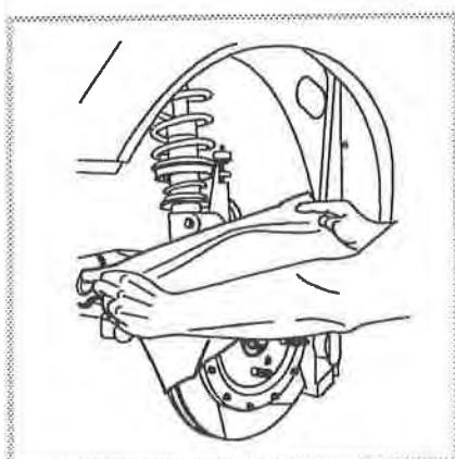
1 soit protéger lors de chaque intervention (à l'assistance ou après rallye lors du nettoyage) le disque de frein par un chiffon pour éviter que des corps étrangers (gravillons etc ...) ne tombent dans les aubes du disque et viennent par la suite lors du remontage de la roue s'intercaler entre le bol du disque et le moyeu de roue et entraînent ainsi un mauvais serrage de la roue.
